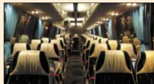
licher Glühlampen-Konstruktion ausgeführt. Die Deckenbeleuchtung ist indirekt, was nach längerer Fahrt im Dunkeln angenehm augenschonend ist. Mitgedacht wurde bei der Gangbeleuchtung, diese befindet sich nur an der linken Seite, somit kann sich nichts in der Windschutzscheibe spiegeln.
