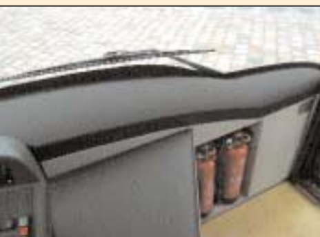
GANZ NEU Materialien aus dem Pkw-Bau veredeln den Frontbereich. Allerdings ist das Material stoßempfindlich
