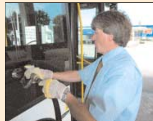
BETANKUNG Beim OmniLink befindet sich der Einfüllstutzen hinter der ersten Tür
