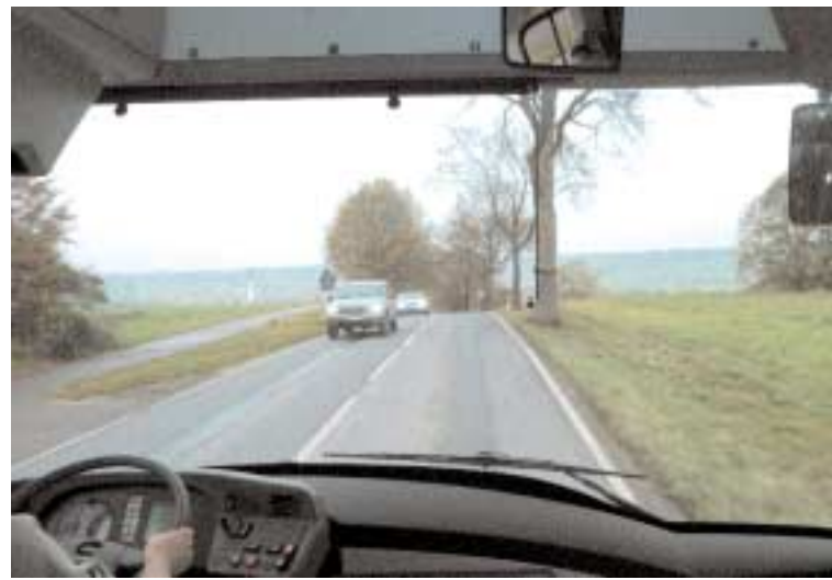
OPTIMALE SICHT Die Frontscheibe fällt nach rechts unten ab
