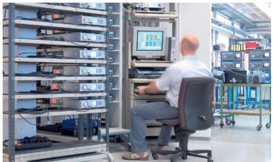
Einen solchen Mehrfach-Prüfstand für die Eichung von AU-Geräten gibt es nur bei AVL DiTEST in Fürth
