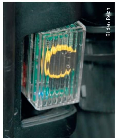
Eine blaue Leuchtdiode signalisiert, dass der Launch Crecorder Daten und Fehlercodes aufzeichnet
