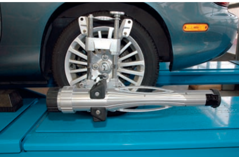
Zum Pod weiterentwickelter Messwertaufnehmer mit Bluetooth-Datenübertragung
