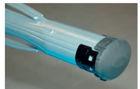
Im hinteren Teil eines Pods befinden sich eine CCD-Einheit und eine Infrarot-Datenschnittstelle
