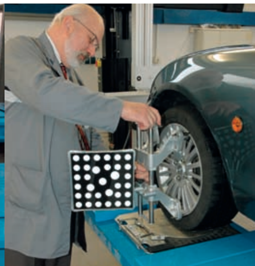
Radklammer und Reflektorträger aus Magnesium
