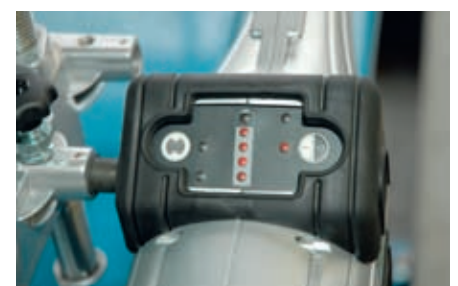
Nur ein Schalter sowie einige LED sind in der Bedieneinheit eines Pods angeordnet
