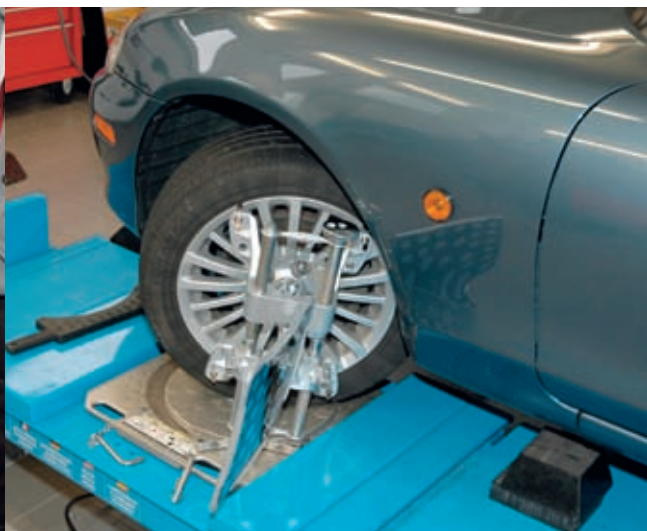
Selbst den maximalen Lenkeinschlag misst das Prism ohne Hilfsmittel
