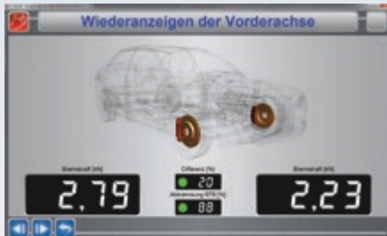
Messwertanzeige: Bremsprüfung der Vorder-/ Hinterachse mit Parkbremse
