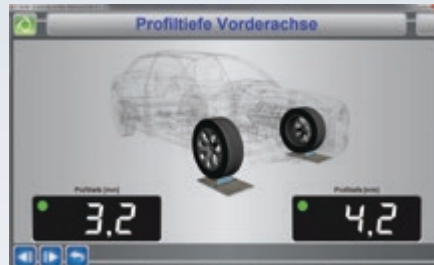
Messwertanzeige: Profiltiefenmessung der Vorder-/ Hinterachse
