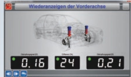
Messwertanzeige: Achsdämpfungsprüfung der Vorder-/ Hinterachse
