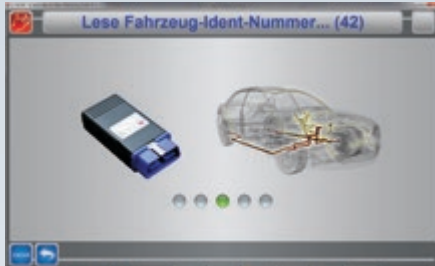
Ermitteln von Fehlercodes der sicherheitsrelevanten elektronischen Fahrzeugsysteme
