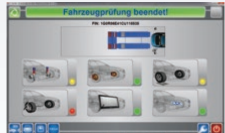
Ergebnisdarstellung der Fahrzeug-Inspektion mit Ausgabe eines Prüfprotokolls
