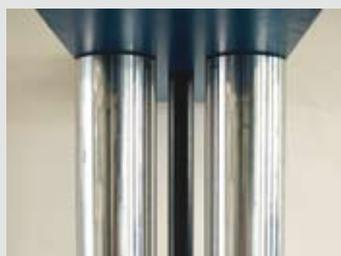
Doppelzylindersystem als Sicherheitseinrichtung gegen Systemausfall und für große Biegesteifigkeit der Hubeinheit.
