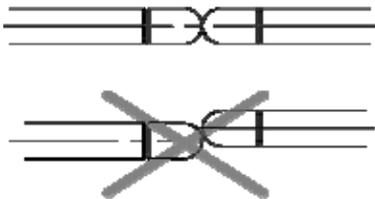
Abb.42: „Elektroden müssen fluchten“
