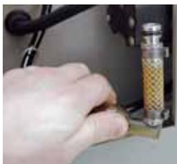
Abb. 108: Wasserfilter gelöst
