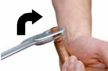
Abb.37: Elektrodenkappen wechseln
