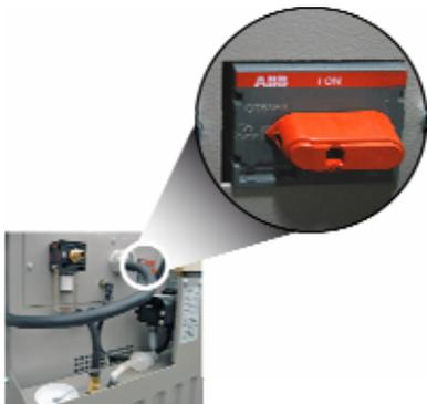
Abb.16: Netzschalter (in „AUS“-Stellung)
