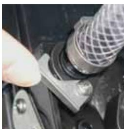
Abb. 107: Kühlwasservorlauf entriegeln
