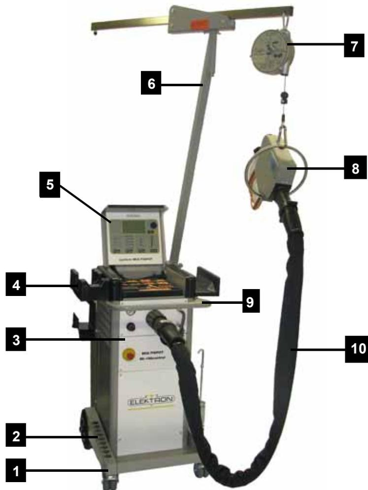
Abb. 12: Übersicht über das Multispot-System (Standard)
