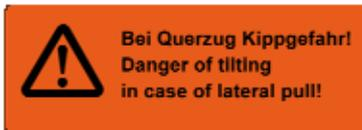
Abb. 11: Warnschild am Balancer
