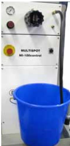
Abb.109: Kühlwasser ablassen
