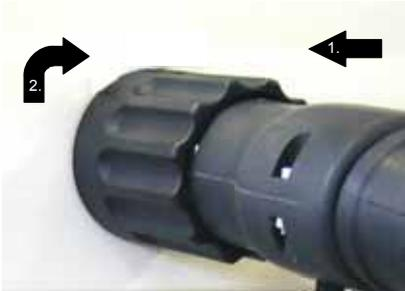
Abb.33: Zentralanschluss der Schweißpistole
