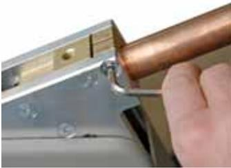
Abb.35: Elektrodenarm lösen
