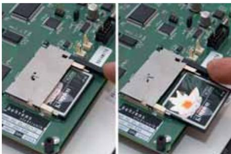
Abb.92: Wechsel der CF-Speicherkarte
