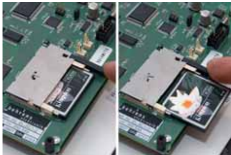
Abb. 88: Wechsel der CF-Speicherkarte
