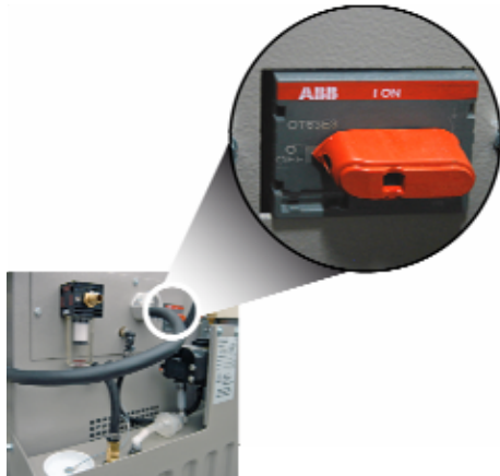
Abb. 14: Netzschalter (in "AUS"-Stellung)
