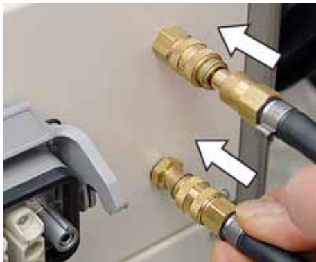
Abb. 31: Wasserkühlung der Zange
