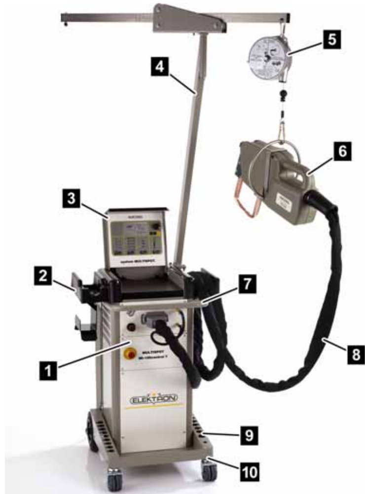
Abb. 9: Übersicht über das Multispot-System (Standard)
