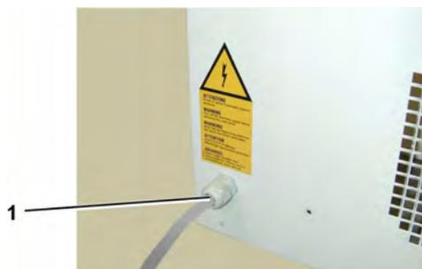
Es empfiehlt sich, die Steckdose, den Magnetothermischalter und die Sicherungen in der Nähe (maximal 3 m entfernt) vom Kompressor zu installieren. Der Magnetothermischalter und die Sicherungen müssen folgende Merkmale aufweisen:
