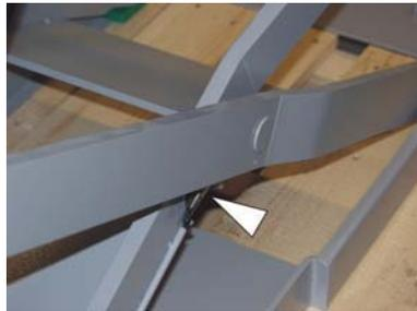
Abb. 6-1 Sensor für obere Position
