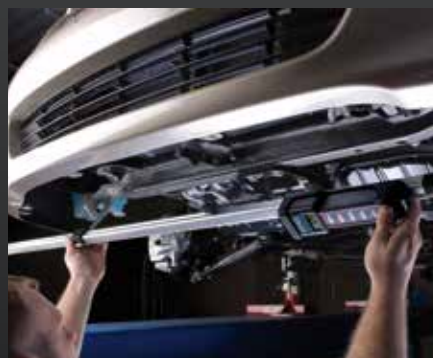
Unterbau Messung der Unterbauabmessungen einschließlich Kugelgelenklänge, Kühlerhalterungen, Querstreben, Motoraufhängung und auch Trägern. Außerdem ist es für eine schnelle Kontrolle einer rautenförmigen Verformung ideal.
