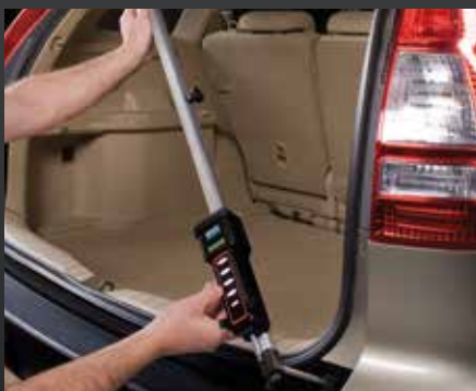
Kofferraum und Heckklappen Alle Längen, Breiten oder diagonale Messungen von Punkt zu Punkt.
