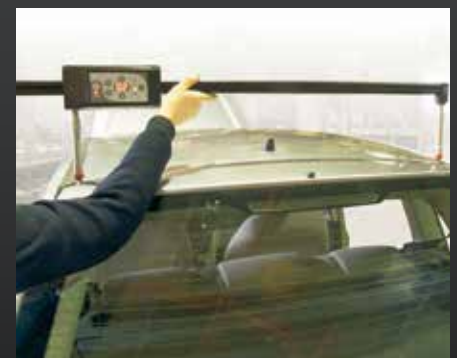
Oberbau Alle Längen, Breiten oder diagonale Messungen von Punkt zu Punkt.
