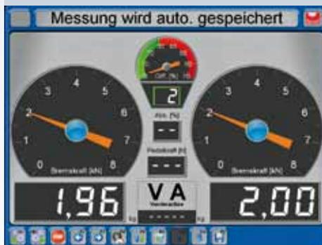
6. Nach der Bremsprüfung werden die zusammengehörenden Messwerte einer Achse übersichtlich dargestellt. Die Messwerte werden automatisch gespeichert.
