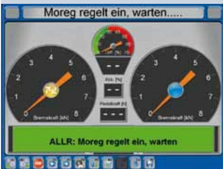
3. Der Prüfstand startet im geregelten Gegenlaufmodus. Die linke Seite wird zuerst geprüft.
