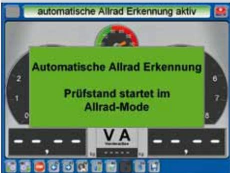
2. Der Prüfstand startet ein zweites Mal und überprüft den Anlaufwiderstand. Wurde der Allradantrieb deaktiviert, kann eventuell eine Bremsprüfung im Standardmodus durchgeführt werden.
