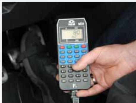
Zur exakten Auswertung der Prüfergebnisse bei gegenläufig drehenden Rollen wird ein Pedalkraftmesser empfohlen.
