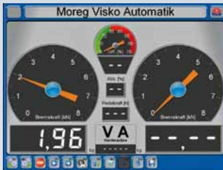
4. Bremsprüfung linke Seite. Die Anzeige der Bremskraft erfolgt immer nur am vorwärts drehenden Rad.
