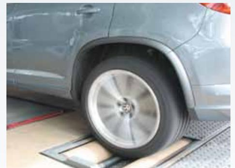
Zum Prüfen der EPB bei Fahrzeugen mit Haldex-Kupplung muss der Sicherheitsgurt angelegt und die Zündung eingeschaltet sein, um den Prüfmodus zu aktivieren.
