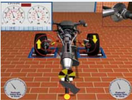
Bei einem unregelmäßigem Allradbremsprüfstand können sich Bremskräfte innerhalb einer Achse übertragen, so dass gravierende Fehler unentdeckt bleiben.
