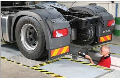
Der Gelenkspieltester ist eine sinnvolle Ergänzung bei der Annahme oder Inspektion, um eine optische Kontrolle der Achsspiele vorzunehmen. Die verzinkten Prüfplatten werden mit Fingerdruck auf die Prüflampe hydraulisch bewegt. Die Prüfplatten sind einzelsteuerbar, in gegenläufiger (4 Wege) oder in gleichlaufender Prüfrichtung (8 Wege) steuerbar.
