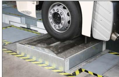
Mit der Hebevorrichtung HBV – nur in Verbindung mit safelane truck 16t/18t mit Radlastwaage – können verschiedene Achslasten simuliert werden. Die Mechaniken werden angehoben und gegen das prüfende Fahrzeug gedrückt.
