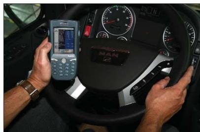
Der PWA (Option) ist ein Pocket-PC mit der Hofmann Prüfstand-Software und Fernbedienung in einem Gerät. Er kann andere Anzeigen, wie Anzeigeschrank und Monitor ersetzen. Der komplette Prüfablauf wird vom Fahrzeug aus gesteuert, dabei werden nur die Funktionstasten eingeblendet, die für den gerade aktuellen Test benötigt werden. Die Bedienung erfolgt über Touchscreen. Als Grundausstattung wird eine PC-Station benötigt.
