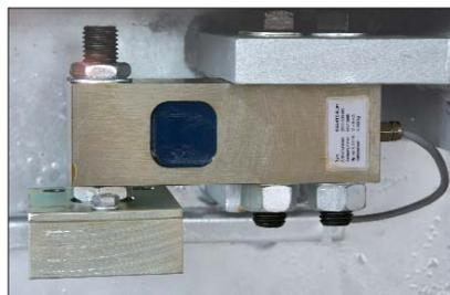
Mit der Achs- oder Radlastwaage werden die Gewichte automatisch erfasst, berechnet und gespeichert. Die Werte werden am integrierten LED-Display (Option) im Anzeigeschrank oder als Bildschirmgrafik auf dem Monitor (Option) angezeigt.
