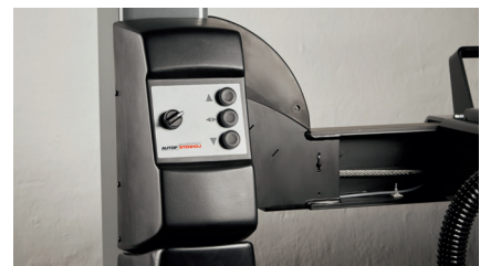
Aggregat und Steuerung an Säule vorne links
