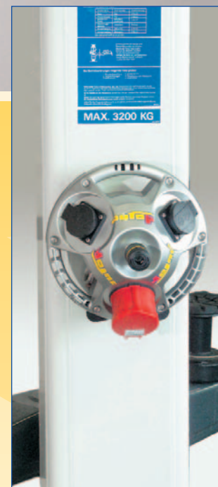
Powerdisc mit Adapteranschluss aus Edelstahl an Säulenbühne montiert.
