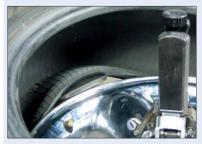
Schnelle Demontage des unteren Wulstes mit dem Abdrückteller. Schnell und einfach.
