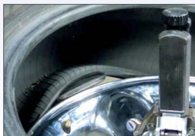
Schnelle Demontage des unteren Wulstes mit dem Abdrücksteller. Schnell und einfach.
