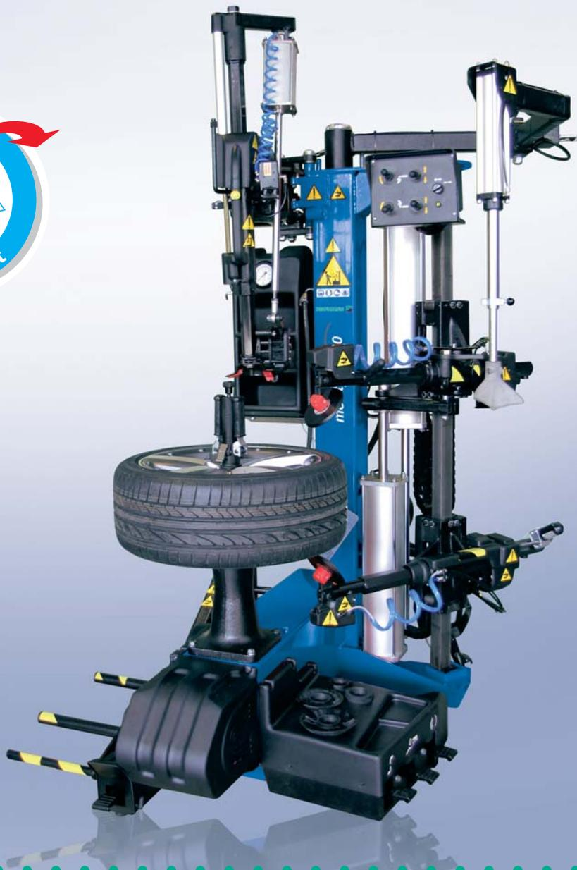
*Reifenmontiermaschine für hohen Durchsatz*
