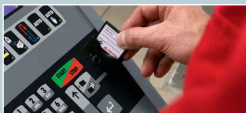
Fahrzeugfüllmengen-Solldatenbank für Pkw auf updatefähiger Speicherkarte
