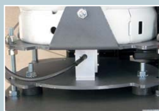
Stoßgeschützte Waagenkonstruktion für den mobilen Einsatz
