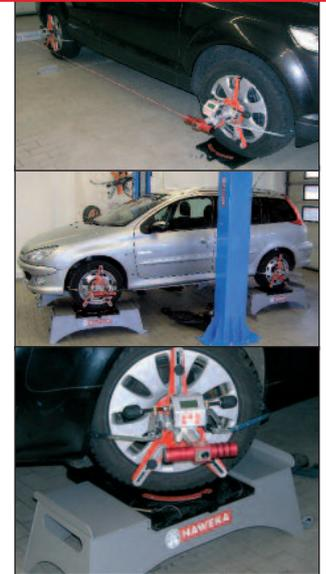
Absetzböcke für die Vermessung von Kraftfahrzeugen auf einer 2-Säulenbühne
