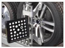
Nach der Montage der vier Reflektoren an den Rädern vergehen nur Sekunden bis eine komplette Vermessung des Fahrzeugs durchgeführt ist. So können mehr Messungen pro Tag durchgeführt werden und Ihre Investition amortisiert sich kurzfristig.
