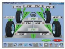
Alle Messwerte werden in einer übersichtlichen dreidimensionalen Grafik dargestellt, dadurch ist eine einfache Gesamtdiagnose möglich.
