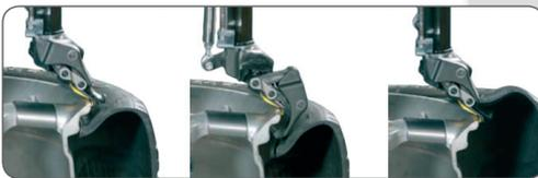
Das Demontagesystem ohne Anwendung des Hebels am Abziehsystem beseitigt jegliche körperliche Belastung für den Bediener und garantiert maximale Sicherheit für Felge und Reifen.
