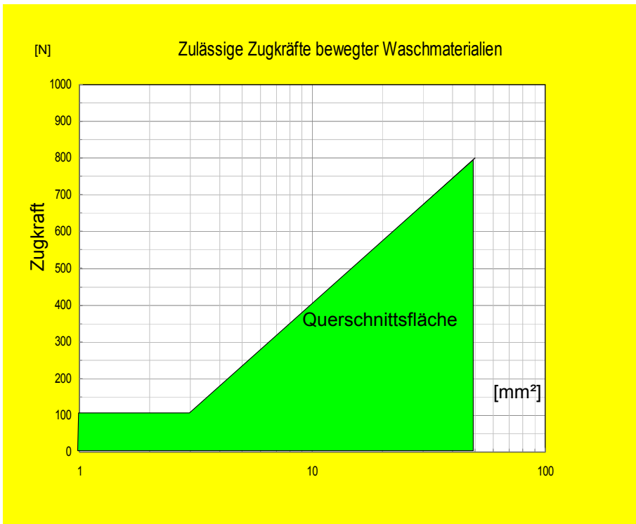
Abbildung 11: Diagramm für Abhängigkeit von Zugkraft zu Querschnitt unter Beachtung der heutigen Kennwerte
