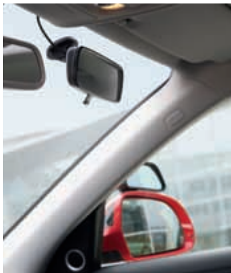
Der abblendbare Innenspiegel ist mit einem Fangseil gesichert, damit er bei einem Unfall keine Verletzungen verursacht
