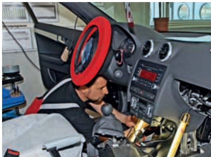
Der Einbau der Doppelbedienung an zwei Montageplätzen für Fahrschulautos ist für das Audi Service Kundendienst Center Ingolstadt tägliche Routine
