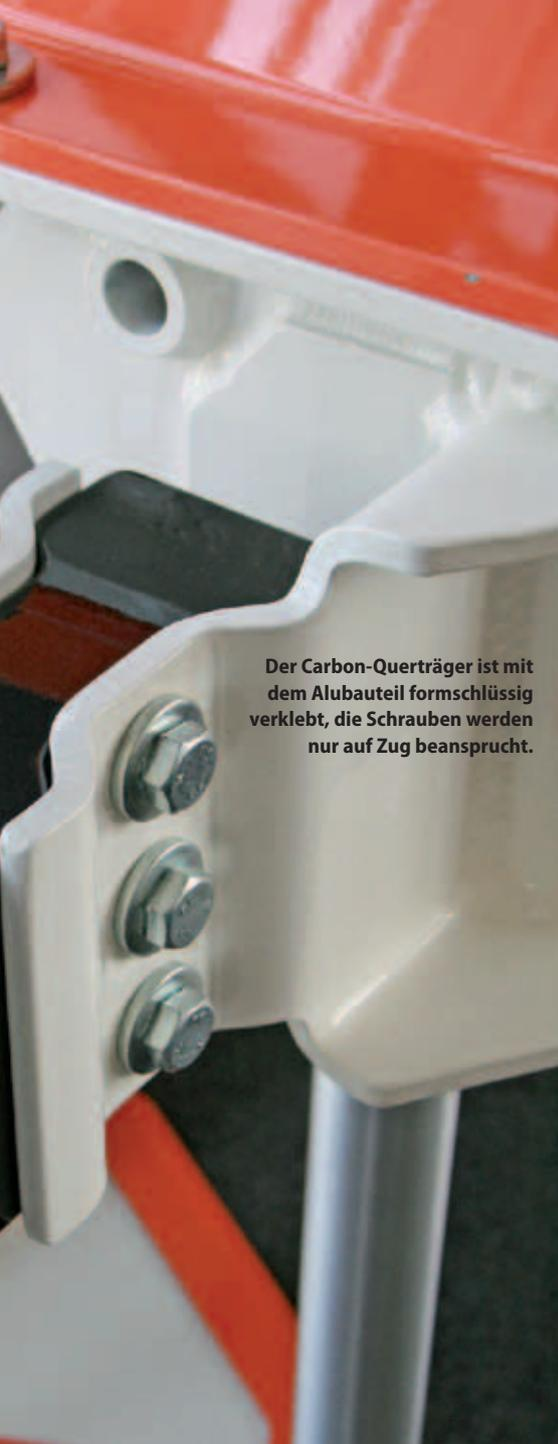
Der Carbon-Querträger ist mit dem Alubauteil formschlüssig verklebt, die Schrauben werden nur auf Zug beansprucht.
