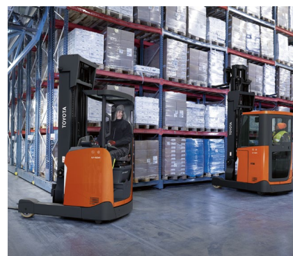
Die Kühlhausmodelle von Toyota sind für Umgebungen bis zu minus 30°C ausgelegt
