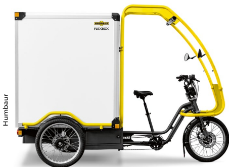
Schwerlastrad von Humbaur mit 270 kg Nutzlast
