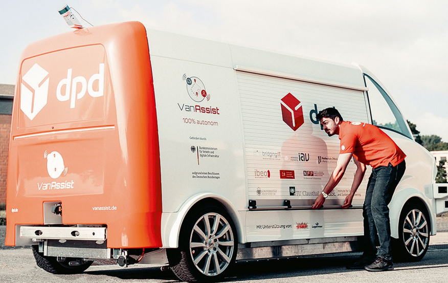
Das VanAssist-Versuchsfahrzeug arbeitet im sogenannten Rendezvous-Modus, damit entfällt die Parkplatzsuche
