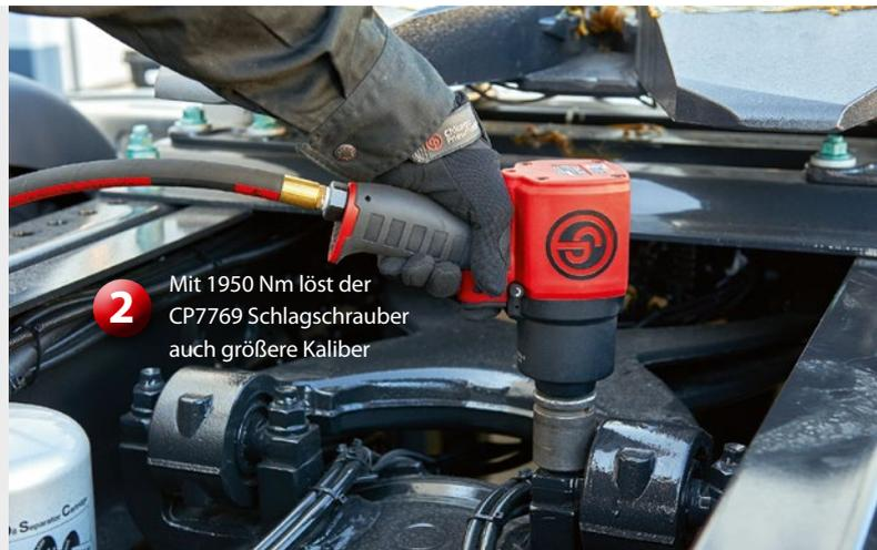
**2** Mit 1950 Nm löst der CP7769 Schlagschrauber auch größere Kaliber
