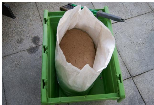
Neben Granulaten werden auch pulverförmige Öl- und Chemikalienbinder angeboten. Sie bilden Klumpen beim Binden der Flüssigkeit.
