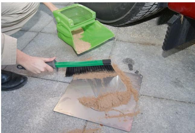
Mit einem geeigneten Besen wird das Bindemittel in die Flüssigkeit „einmassiert“.
