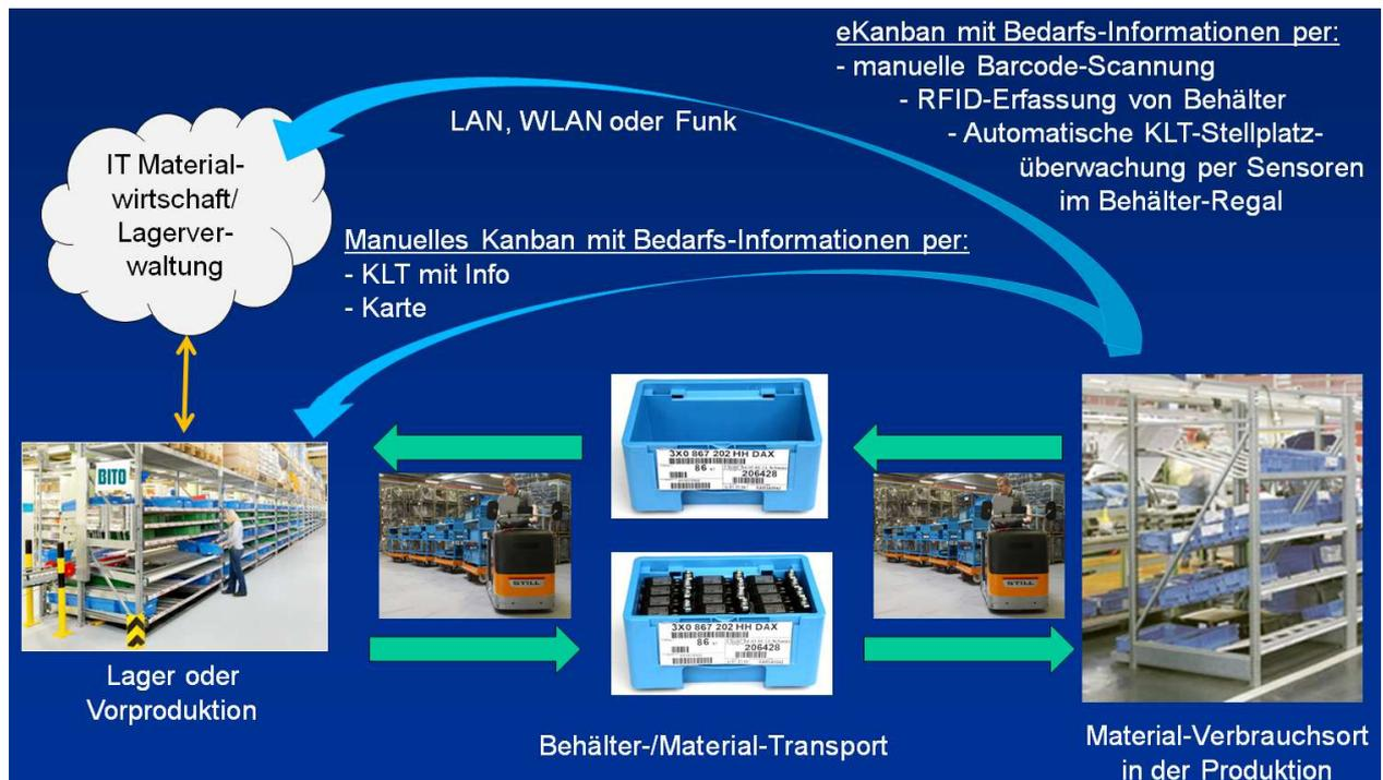
Abbildung 4: Kanban-System zur Fertigungs- und Materialflusssteuerung
