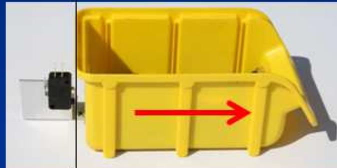
Abbildung 7b: Überwachung von Kleinteile-Behältern am Arbeitsplatz mit Hilfe von RFID-Lesegeräten oder Micro-Schaltern
