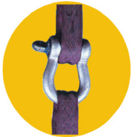
Abb. 68: Sinnvolle Verlängerung einer Rundschlinge unter Verwendung eines Schäkels
