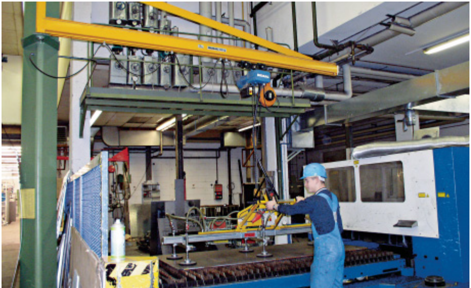
Abb. 48: Säulenschwenkkrane mit speziellem Lastaufnahmemittel
