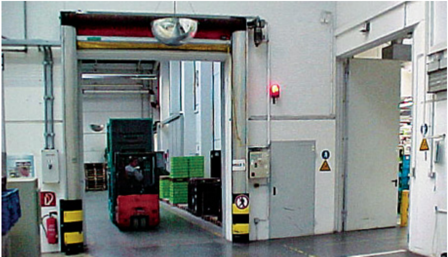
Abb. 79: Gute Hilfsmittelkombination zur Gefahrenreduzierung (Spiegel + Rundumkennleuchte)
