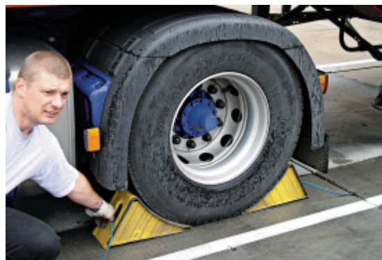
Abb. 57: Sicherung des Fahrzeuges mittels Unterlegkeilen am Rad
