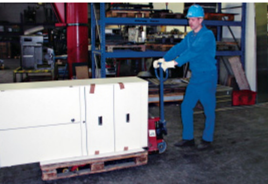
Abb. 31: Hydraulisch betätigter Handgabelhubwagen
