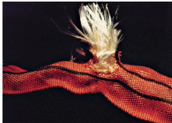
Abb. 72: Durch Schnitte beschädigte Ummantelung und Einlage
