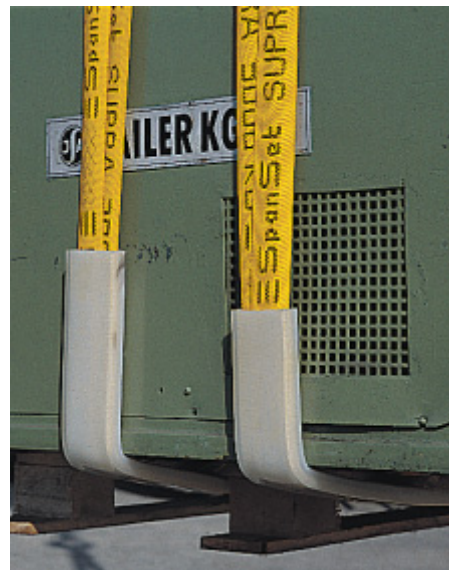
Abb. 70: Schutzschlauch als Schutz vor scharfer Kante
