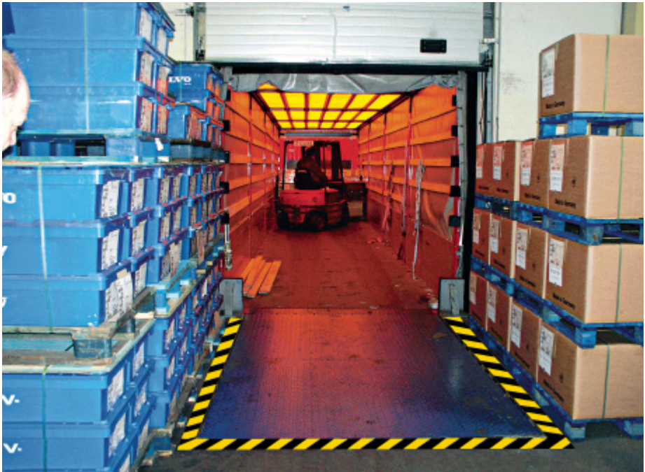
Abb. 74: Hydraulisch betätigte Ladebrücke
