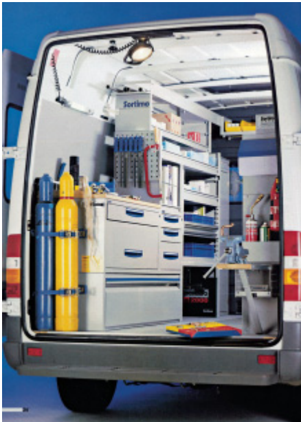
Abb. 62: Beispielhafte Ladungssicherung in einem Kastenwagen
