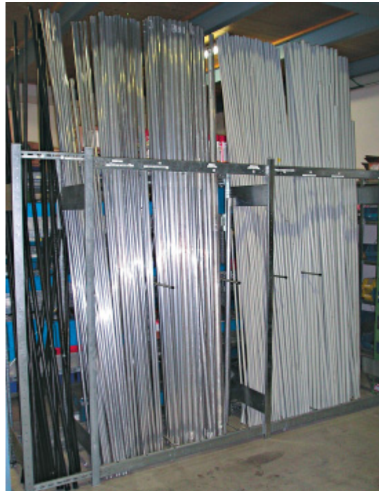
Abb. 25: Lagern und Stapeln von Rohrmaterial
