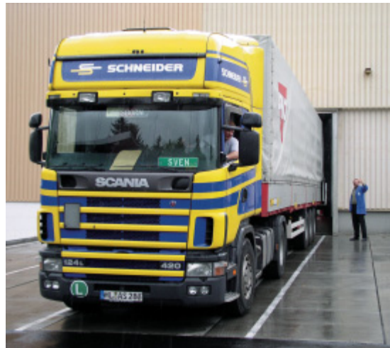
Abb. 58: Einweiser beim Rückwärtsfahren
