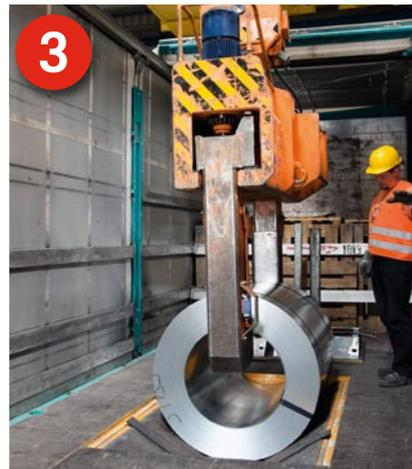
**3** Beladung: Das Coil muss formschlüssig – mit Kontakt an die Steckungen heran – geladen werden.
