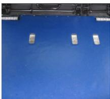
Unser eigens gefertigter und individuell angepasster Fuhrmann Holzboden mit abriebfestem PVC Belag ist hervorragend für den Transport von Rollstühlen geeignet.
