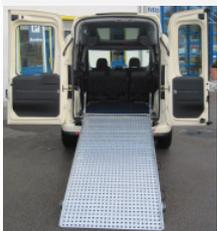
Eurorampen von AMF-Bruns werden aufrecht stehend im hinteren Bereich des Fahrzeugs montiert und können manuell ausgeklappt werden. Dabei verdoppelt sich die Länge der Rampe. Je nach Fahrzeug können verschiedene Längen und Breiten verbaut werden.
