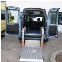
Der Standard Linearlift "Easy Access" von AMF ist ein vollautomatischer Behindertenlift für den Heck- oder Seitentüreinstieg von Rollstuhlfahrern und gehbehinderten Menschen.
