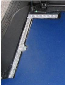
Airlineschienen bieten die Basisbefestigung als Verbindung zum Fahrzeug für diverse Verzurr- und Rückhaltesysteme. Diese können eben in den Boden eingearbeitet oder auf den Boden aufgesetzt montiert werden. Standardmäßig werden zwei Schienen benötigt, 1 x vor dem und 1 x hinter dem zu befestigenden Rollstuhl
