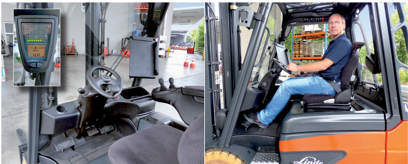
Ungewöhnliche Displayposition, mit Anzeige der realen Batterierestlaufzeit (links). Der Fahrerplatz ist geräumig, bequem und gut bedienbar (rechts)
