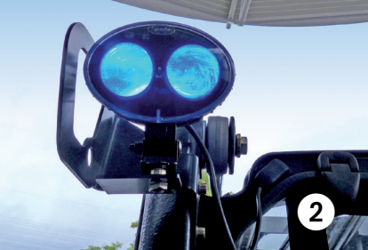
Schmale Mastprofile erlauben eine gute Sicht nach vorne (1). Die blauen Lampen ersetzen bei der Rückwärtsfahrt den Piepton (2). Unebenheiten, wie Schwellen oder Rampen, fängt die Chassis-konstruktion gut ab (3). Der Stauraum in der Armlehne ist knapp bemessen (4). Das Onboard-Ladegerät sorgt für frischen Strom in der Batterie (5). Einstieg: Gute Trittstufe, aber der Handgriff könnte besser platziert sein (6).
