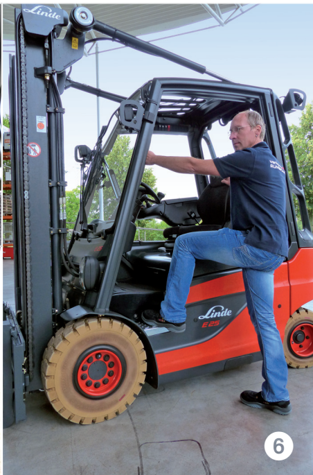
Schmale Mastprofile erlauben eine gute Sicht nach vorne (1). Die blauen Lampen ersetzen bei der Rückwärtsfahrt den Piepton (2). Unebenheiten, wie Schwellen oder Rampen, fängt die Chassis-konstruktion gut ab (3). Der Stauraum in der Armlehne ist knapp bemessen (4). Das Onboard-Ladegerät sorgt für frischen Strom in der Batterie (5). Einstieg: Gute Trittstufe, aber der Handgriff könnte besser platziert sein (6).
