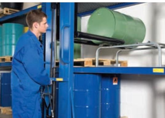
Fasslifter mit Bock- und Lenkrollen ermöglichen das Aufnehmen, Transportieren, Ein- und Auslagern von liegenden Fässern.
