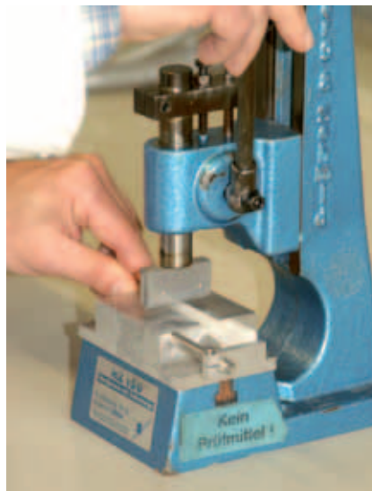
Der neue Probekörper wird vor dem Test maßgenau eingekerbt.
