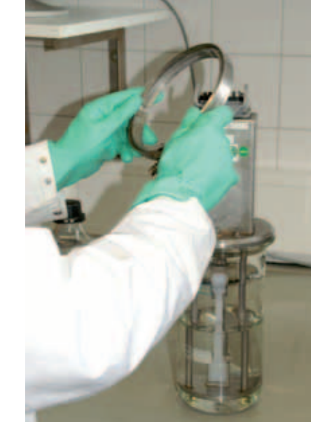
Der Probekörper im Behälter mit Prüffüllgut.
