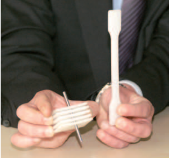
Im Vergleich: der alte Probekörper mit Metallstift (li.) und der neue, leichter herzustellende Schulterstab.
