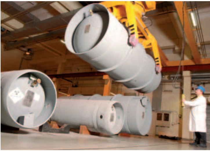
Uranhexafluorid (UF6) wird mit angereichertem U-235 in 30B-Zylindern, mit abgereichertem in 48Y-Zylindern befördert.
