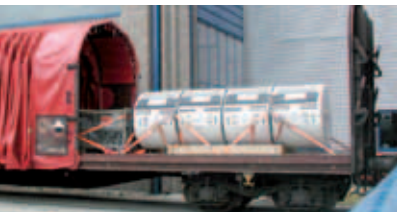
48Y-Zylinder sind mit einem Thermoschutz versehen.
