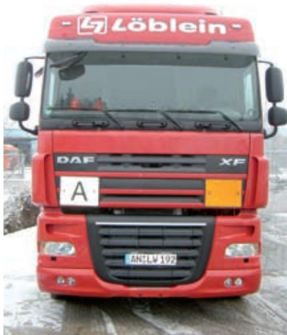
Zusätzlich zur ADR-Kennzeichnung müssen LKW vorne und hinten ein „A-Schild“ tragen.
