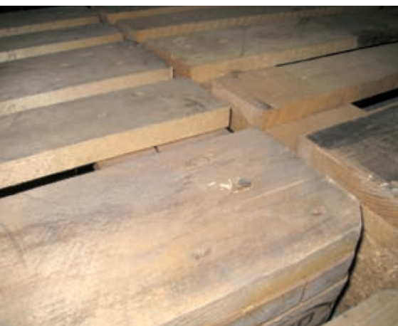
Herausstehende Nägel in der Palette hatten zur Beschädigung des Kanisters geführt.
