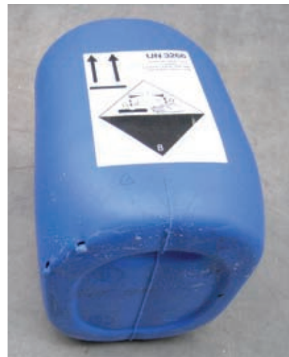
Durch die kleinen Löcher auf der Unterseite waren 30 Liter Säure ausgelaufen
