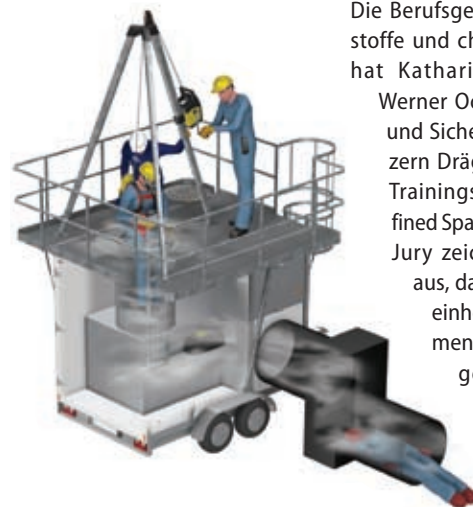
Einstieg leicht gemacht: Das Schema zeigt die mobile Trainingsanlage im Aufriss.
