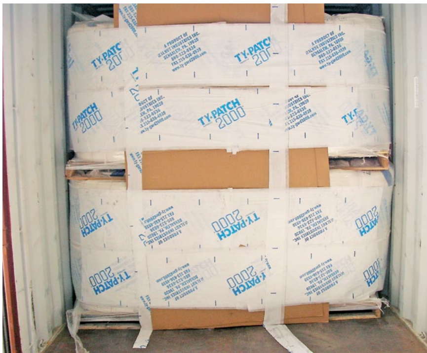
An den Seitenwänden angeklebt halten die Ty-Gard-Bänder das Ladegut fest.
