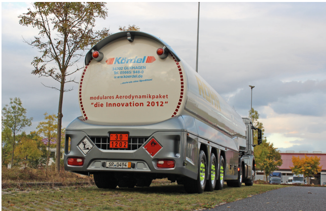
Glatter Tanker: Der verkleidete Aero-Tanksattel von Rohr soll den Fahrtwind förmlich streicheln und so bis zu acht Prozent Sprit sparen. Über erste Erfolge am Markt freut sich Silo-Spezialist Spitzer bei seinem in Composit-Bauweise gefertigten Behälter.
