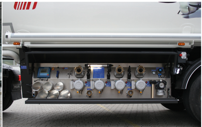
Gefahrgut-Sattelaufleger mit drei Kammern und 33.000 Liter Fassungsvermögen von Schrader. Neu ins Willig-Programm kam ein leichter, zweigeteilter Armaturenschrank mit nach oben zu öffnender Klappe, die mechanisch oder pneumatisch geöffnet werden kann.
