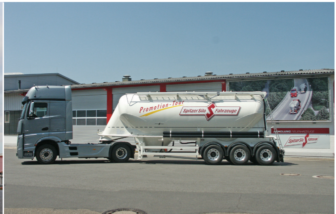
Glatter Tanker: Der verkleidete Aero-Tanksattel von Rohr soll den Fahrtwind förmlich streicheln und so bis zu acht Prozent Sprit sparen. Über erste Erfolge am Markt freut sich Silo-Spezialist Spitzer bei seinem in Composit-Bauweise gefertigten Behälter.
