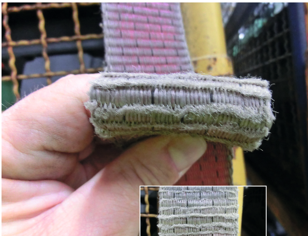
Die Sichtkontrolle bringt es an den Tag: Das Garn ist beschädigt, der Zurrgurt sollte abgelegt werden.
