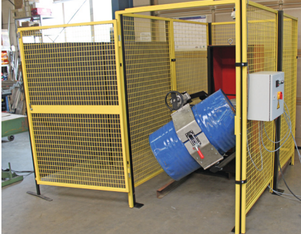
Die Fassmischsäule ist einfach zu bestücken und erlaubt das Mischen in zwei Achsen.
