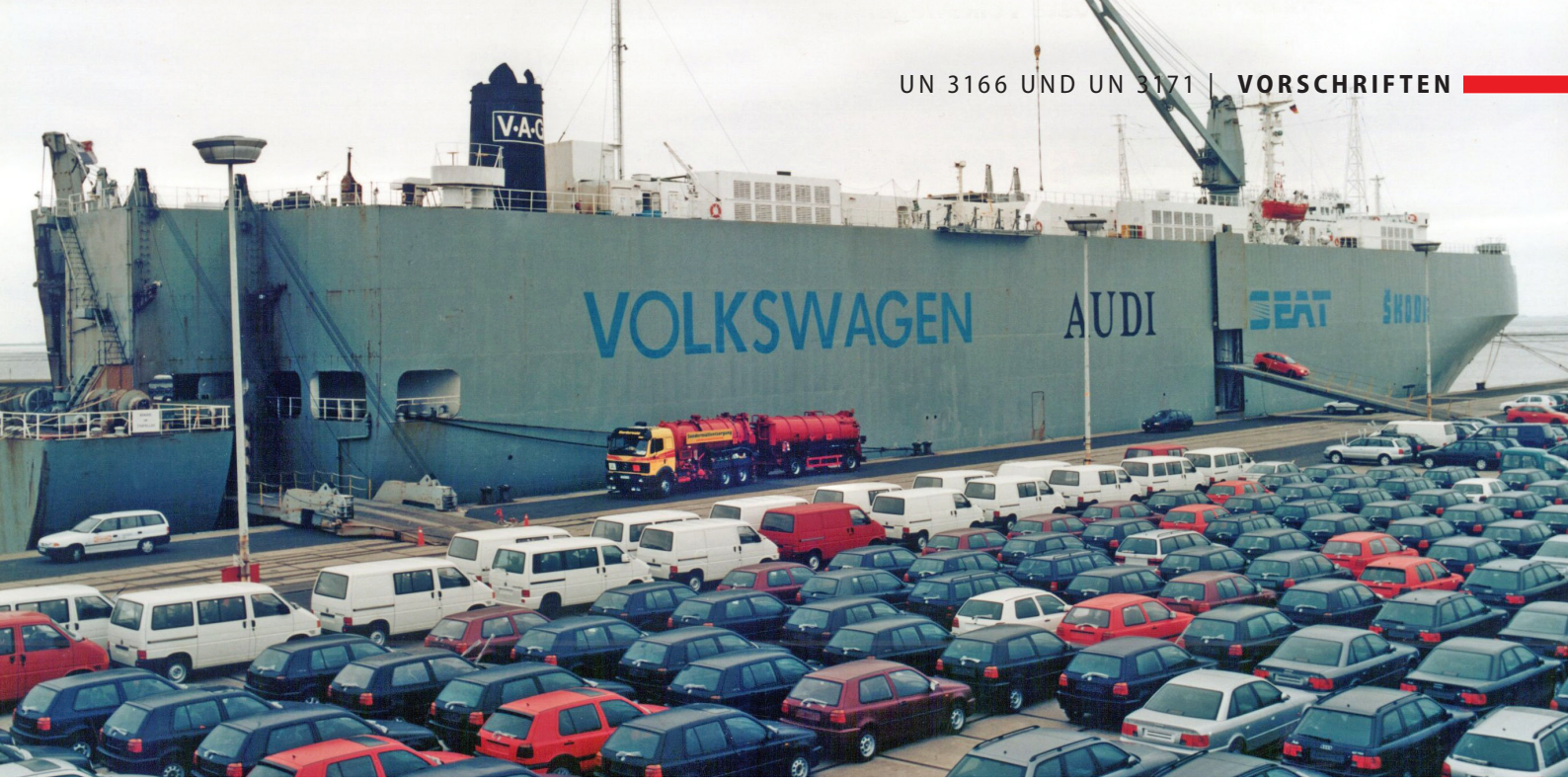
Autotransporter, Sonderform des RoRo-Schiffes. Die Kapazität der großen, für den Überseedienst gebauten Schiffe beträgt bis zu 6400 Fahrzeuge.
