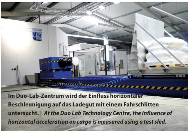
Im Duo-Lab-Zentrum wird der Einfluss horizontaler Beschleunigung auf das Ladegut mit einem Fahrschlitten untersucht. | At the Duo Lab Technology Centre, the influence of horizontal acceleration on cargo is measured using a test sled.
