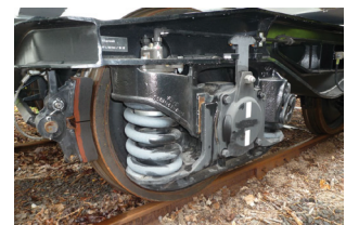
Während die LL-Sohle zur Nachrüstung an Waggons entwickelt wurde, ist die funktionsgleiche K-Sohle (im Bild) für Neubauten gedacht.
