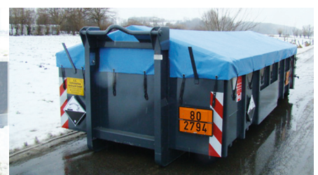
In Paloxen verboten, in den Containern erlaubt: die lose Schüttung von Batterien.
