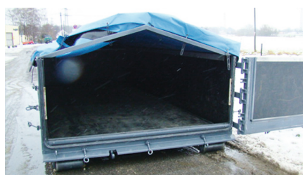
In Paloxen verboten, in den Containern erlaubt: die lose Schüttung von Batterien.
