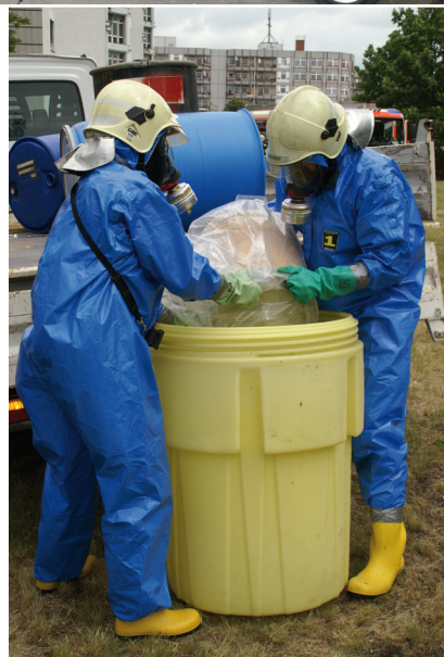
oben: Bergungsdruckgefäß zur Entsorgung alter Gasflaschen.
