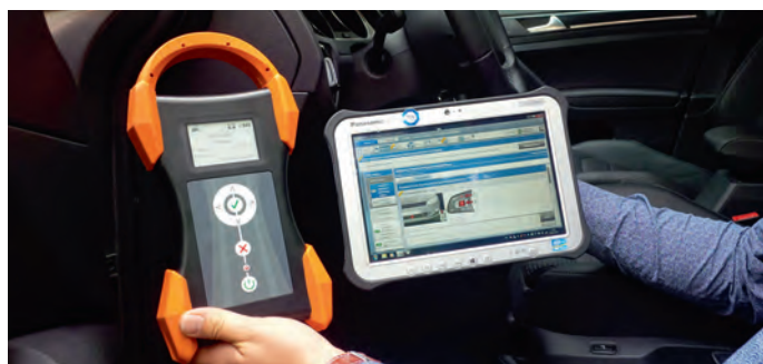
Mit dem HU-Adapter können elektronische Systeme überprüft werden
